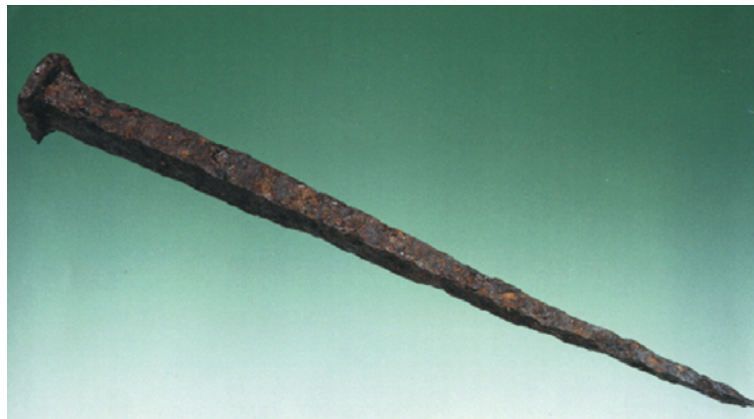
Abb. 23 Photo eines Nagels (ca. 35 cm Länge) von der Fundstätte Inchuthill, Schottland. Der Nagel war 1860 Jahre vergraben /MIL 00/
