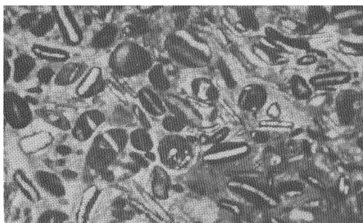
Abb. 26 Mikrophotographie von bitumenhaltigem Kalkstein; Bildbreite = 7,5 mm /HEL 89/
